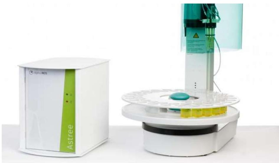
La langue électronique ASTREE est basée sur une technologie de capteurs liquides ChemFET et une mesure de conductivité. Elle permet une analyse du goût de façon globale et spécifique à travers certains attributs (salé, acide, gras).
